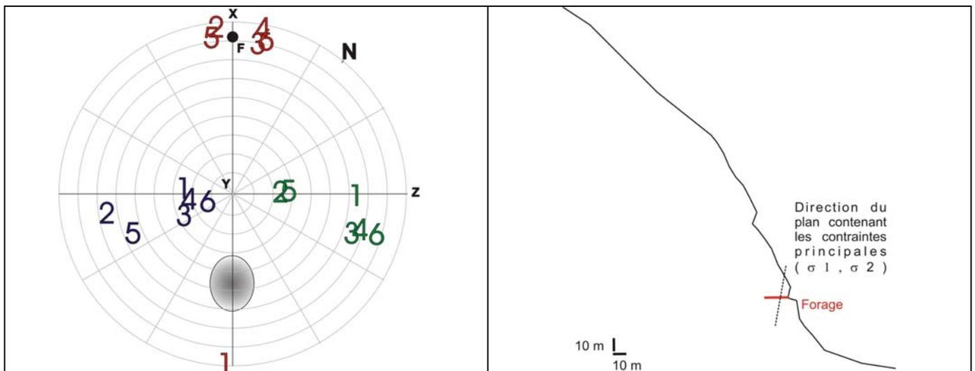
Figure 7. Synthèse de l'orientation des contraintes principales  $\sigma_1$ ,  $\sigma_2$ ,  $\sigma_3$ , pour les six essais (pour chaque essai indiqué de 1 à 6 sont figurées en rouge  $\sigma_3$ , en vert  $\sigma_2$  et en bleu  $\sigma_1$ ). Le point  $F$  représente l'axe du forage. L'ellipse grisée figure l'orientation moyenne  $N45^\circ E-40^\circ SE$  d'une famille importante de fractures, reconnues sur le site.
