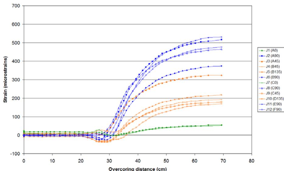
Figure 3. Exemple de courbes de déformations (axe Y -  $\mu$ déf.) enregistrées en fonction de l'avancement du surcarottage (axe X - cm) pour une cellule implantée à la cote 15,75 m. *En vert, les mesures des jauges 1 et 7 parallèles à l'axe de la cellule sont identiques, en rouge les jauges à 45° et 135° et en bleu les jauges circonférentielles à 90°.*
