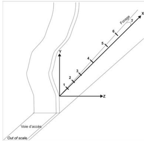
Figure 5. Repère local (X, Y, Z) défini pour les essais de l'expérimentation VAL-STRESS3D.
