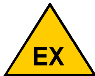
Figure 1 : Panneau de signalisation des emplacements dans lesquels une ATEX peut se former
