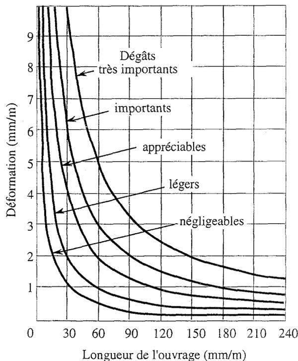
Figure 5 : Caractérisation des dégâts résultant des déformations horizontales.
