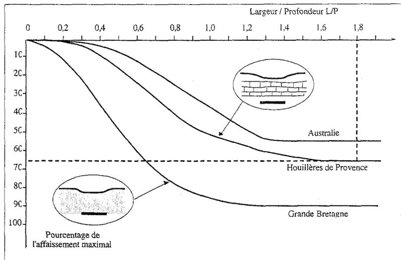
Figure 7 : Profil d'affaissement pour différents types de recouvrement.
