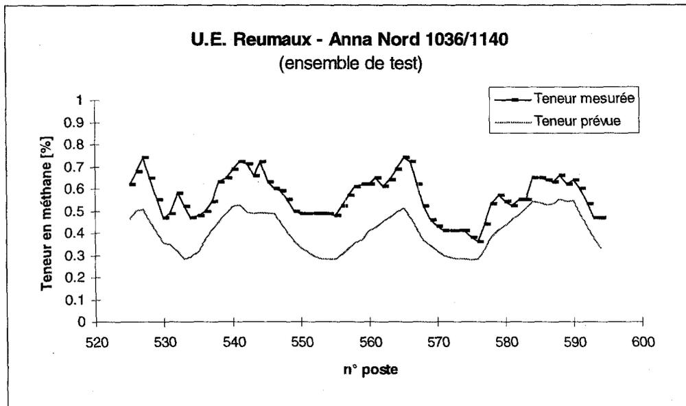
Figure 4 : Prévion des dégagements de grisou (pas de temps : 8 heures)
