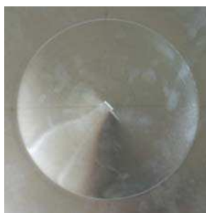
FIG. 8 – plaque de 1 mm en alu 2017, déflagration à 0.8 bar
