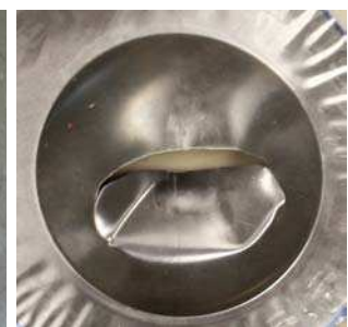
FIG. 11 – plaque de 0.5 mm en alu 5754, détonation à 0.6 bar
