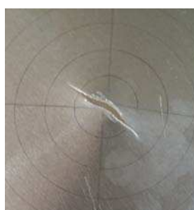
FIG. 10 – plaque de 0.5 mm en alu 5754, déflagration à 0.6 bar
