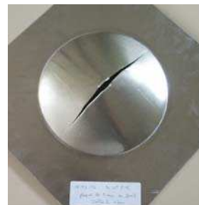
FIG. 7 – plaque de 2 mm en alu 2017, déflagration à 1 bar
