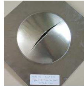
FIG. 7 – plaque de 2 mm en alu 2017, déflagration à 1 bar
