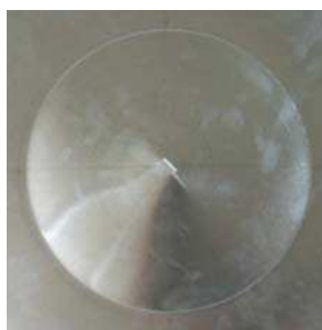
FIG. 8 – plaque de 1 mm en alu 2017, déflagration à 0.8 bar
