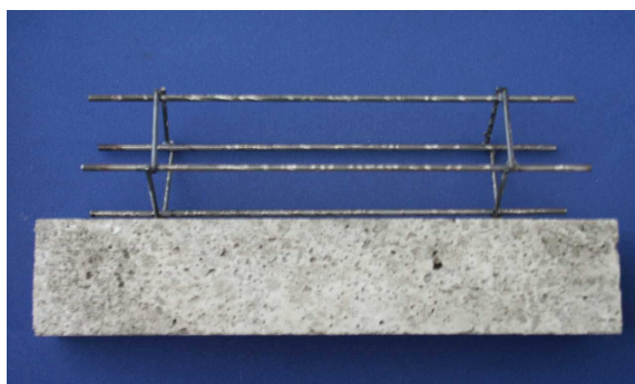
FIG.2 – Eprouvette de béton armé présentée avec son armature
