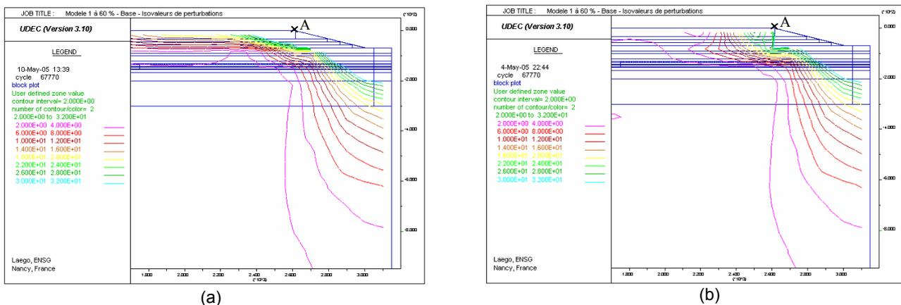
Figure 3: Maximum perturbation rate of stresses in relation to initial stresses for the «  $K_{ns} ++$  » (a) and «  $K_{ns} --$  » (b)
