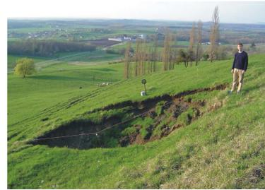
Figures 2.a. Montée de voûte, 2.b. Soufflage du mur, 3.c. Cuvette de fontis en surface.
