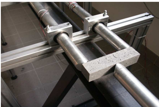
FIG. 1 – Dispositif d'essai de flexion dynamique
