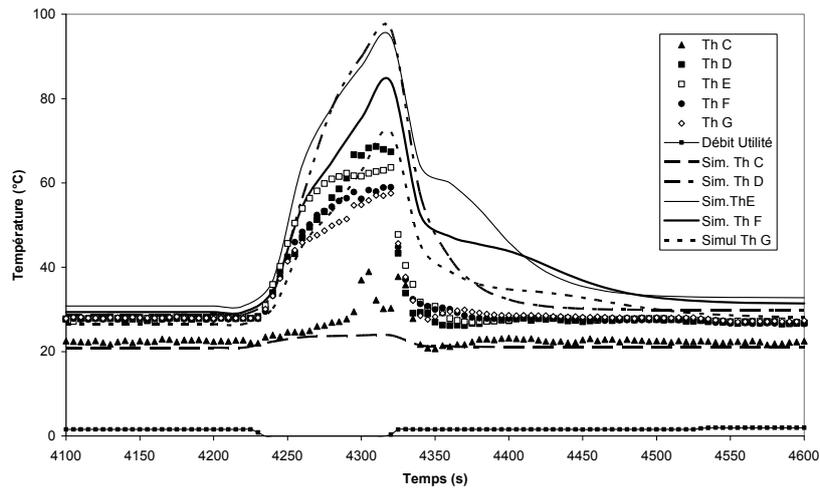
Figure 4. Profils de températures du milieu réactionnel mesurés et simulés au cours du temps dans l'OPR : hypothèse du mode de transfert de chaleur conductif lors de l'arrêt du fluide « utilité » :  $h_{fu} = 200 \text{ W m}^{-2} \text{ K}^{-1}$ .
