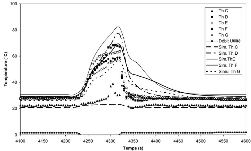
Figure 5. Profils de températures du milieu réactionnel mesurés et simulés au cours du temps dans l'OPR : mode de transfert de chaleur par conduction ( $h_{fu} = 200 \text{ W m}^{-2} \text{ K}^{-1}$ ) puis par convection naturelle ( $h_{fu} = 1200 \text{ W m}^{-2} \text{ K}^{-1}$ ).
