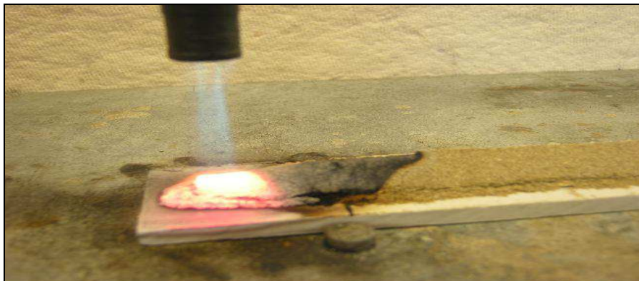
Photo 2 : Vue rapprochée de l'essai d'inflammation.
