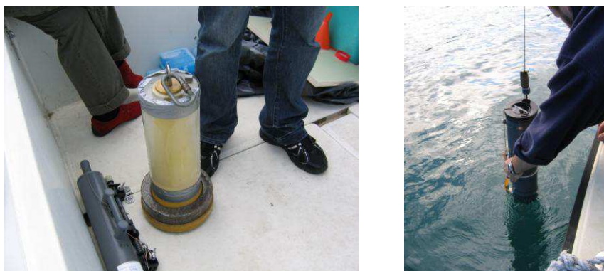
Figure 2 : Exemple de bouteille pour le prélèvement intégré et pour le prélèvement du fond
