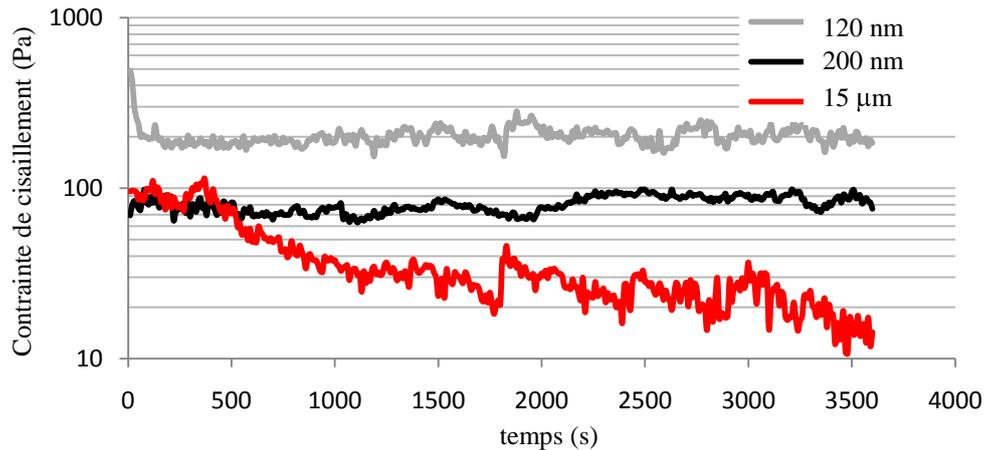
Figure 5. Evolution de la contrainte de cisaillement au cours du temps pour l'aluminium avec  $d_p = 120 \text{ nm}$ , 200 nm et 15  $\mu\text{m}$ , soumis à des vibrations de fréquence constante  $E_v = 50 \text{ Hz}$ .
