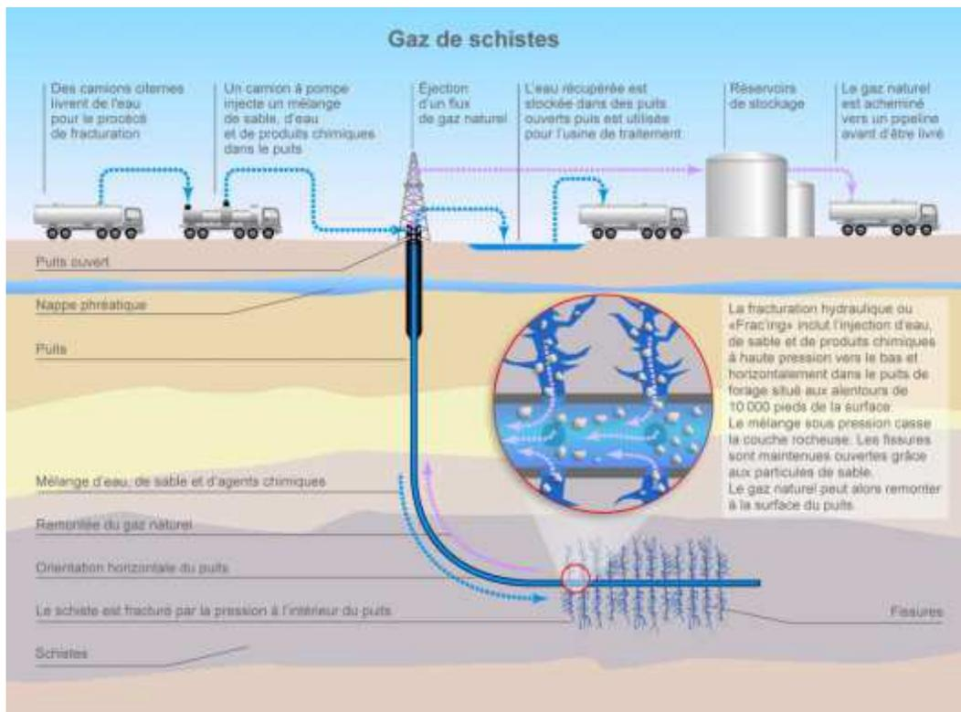
Figure 1 : Principe d'exploitation par fracturation hydraulique (source <http://www.connaissancedesenergies.org>).
