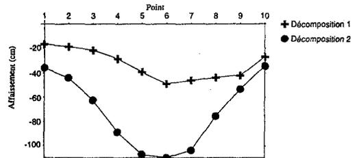
Figure 12 : Comparaison des affaissements des décompositions 1 et 2 par rapport à la base 1.
