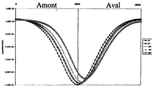
Figure 19 : Cuvettes d'affaissement des différents modèles.
