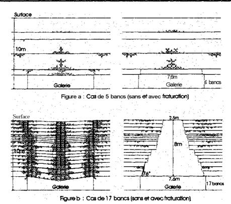
Figure 3 : Résultats obtenus en fonction du nombre de bancs du recouvrement
