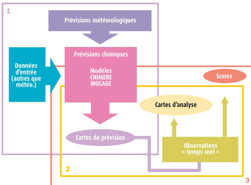
Schéma de principe du système PREV'AIR.
