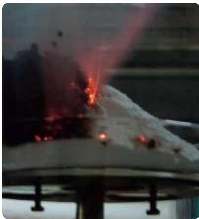
Amorçage de la combustion auto-entretenu du mélange fumigène (échantillon à 30 % de lactose, 30 % de féculé de pomme de terre et 40 % de \text{KNO}_3 ).
