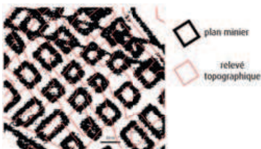
FIGURE 1 EXEMPLE D'INCERTITUDE SUR LA DONNÉE : COMPARAISON ENTRE PLAN MINIER GÉORÉFÉRENCÉ ET RELEVÉ TOPOGRAPHIQUE RÉEL (DONNÉES GEODERIS)
