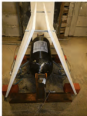
Figure 1 / Montage expérimental, confinement et position des thermocouples.
