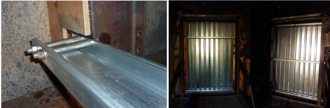
Figure 2 : fixation des lisses sur la structure support / configurations d'appuis n°1 et 2
