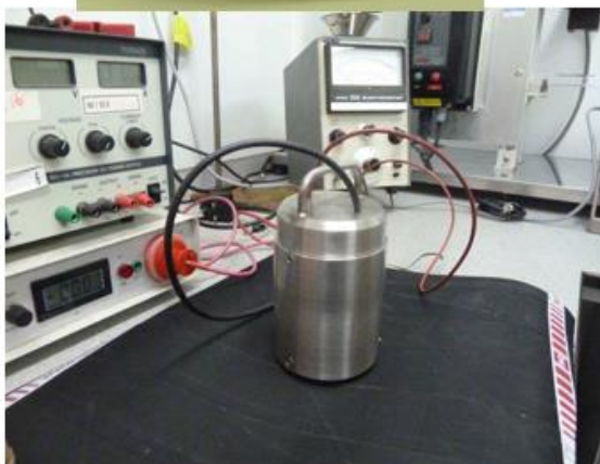
Figure 4 : Vues des montages de réalisation de la mesure de la résistance de surface et transversale de géomembranes
